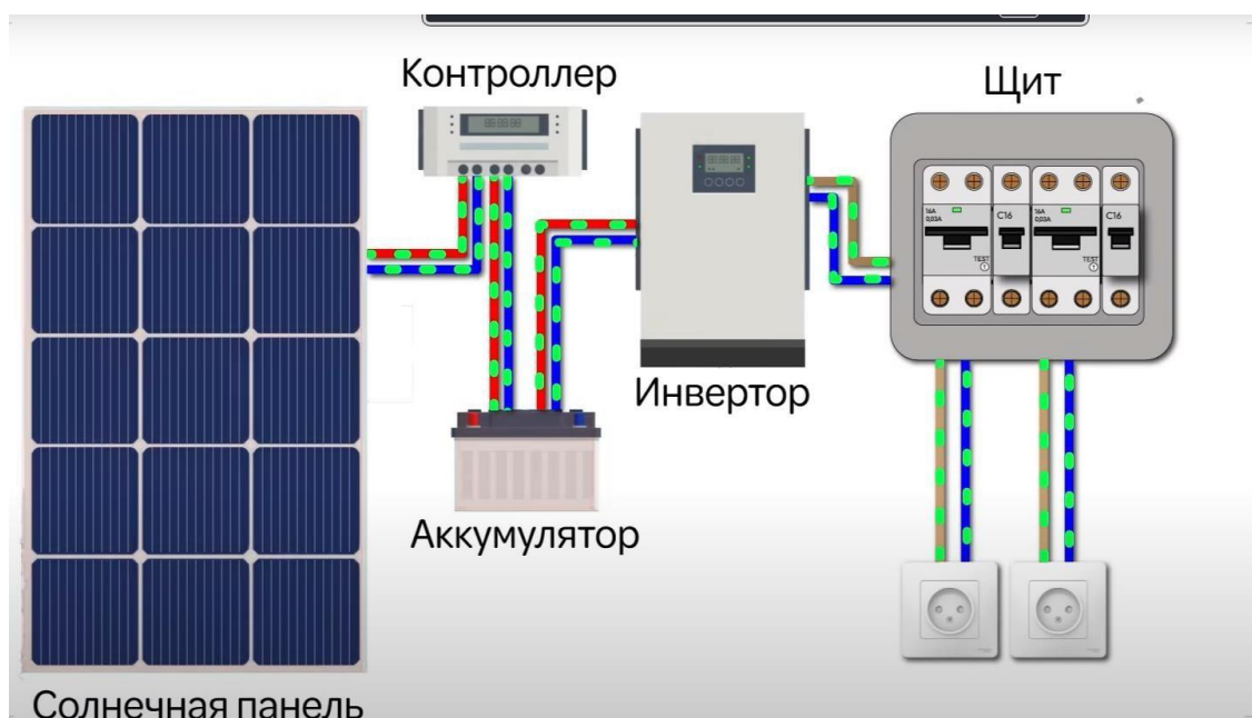
Рисунок 1.1 – Принцип преобразования солнечной энергии в электрическую
